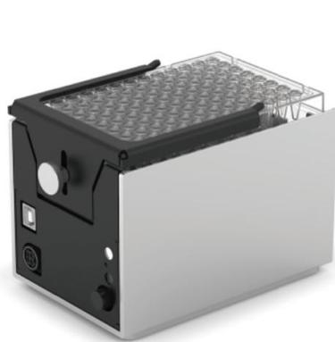
带有0.2ml 96孔PCR板的磁性模块
